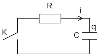
$$\left\{ \begin{array}{l} t < 0 : K \text{ ouvert} \\ \quad \quad q = q_0 ; i = 0 \\ t > 0 : K \text{ fermé} \end{array} \right.$$
