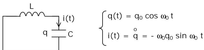
Il s'agit d'un oscillateur électromagnétique.
